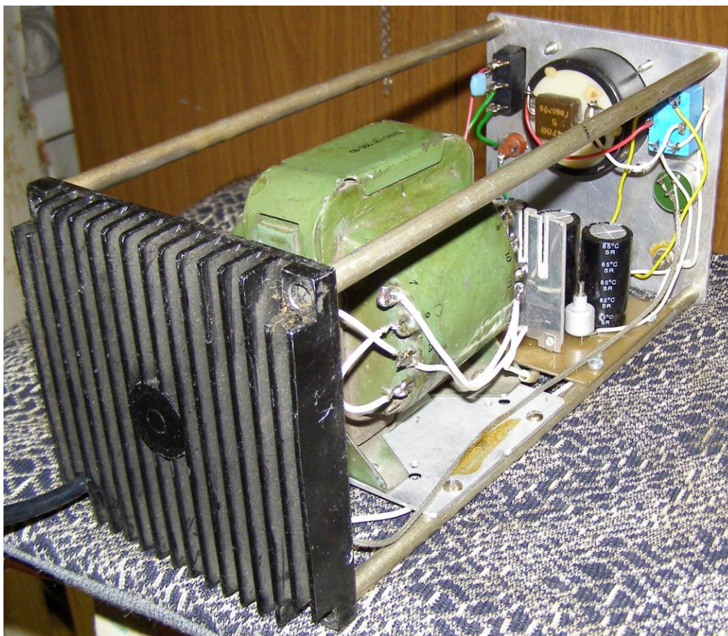
Рис. 9. Блок питания 13,8 В 10 А. Вид на БП сзади со снятой крышкой корпуса
